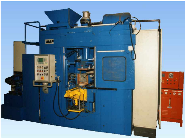
Abb.1: 12 Liter Kernschießmaschine System MAP mit Begasungsgerät (rot)
