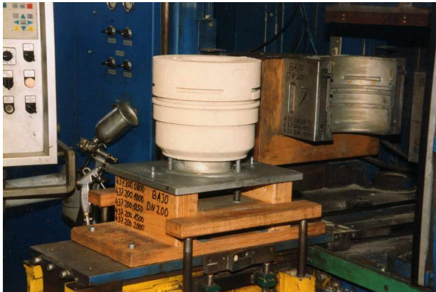
Abb.3: Kernschießmaschine mit vertikal geteiltem Kernkasten und auf dem ausgefahrenen Maschinentisch befindlichen Kern
