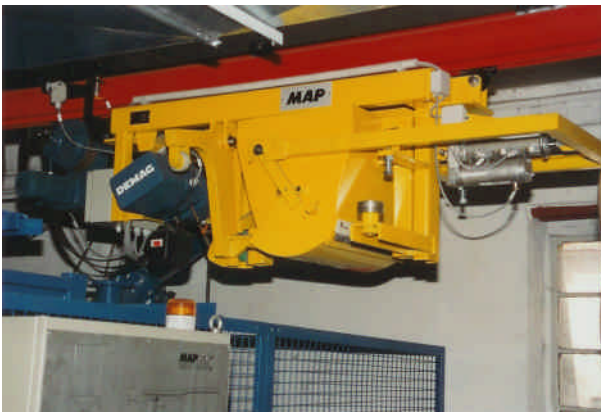
Abb.4: Hublaufkatze in flacher Bauweise
