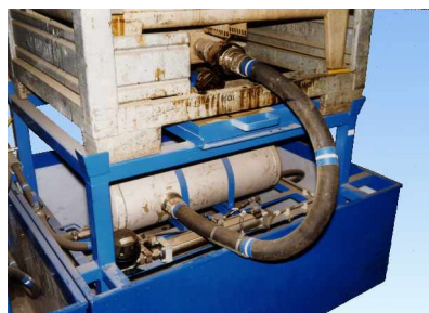
Abb. 2: Detail Anschluss Bindemittel-Container
